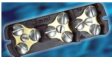
Slika 13.4 Stezaljka za univerzalnu kutiju - radi razvoda bez prekida i izvođenja odcjeka na instalacijske uređaje, nazivni napon: 400 V ~, 3-polna s 3 x 2,5 mm 2 spojnih mjesta po polu
